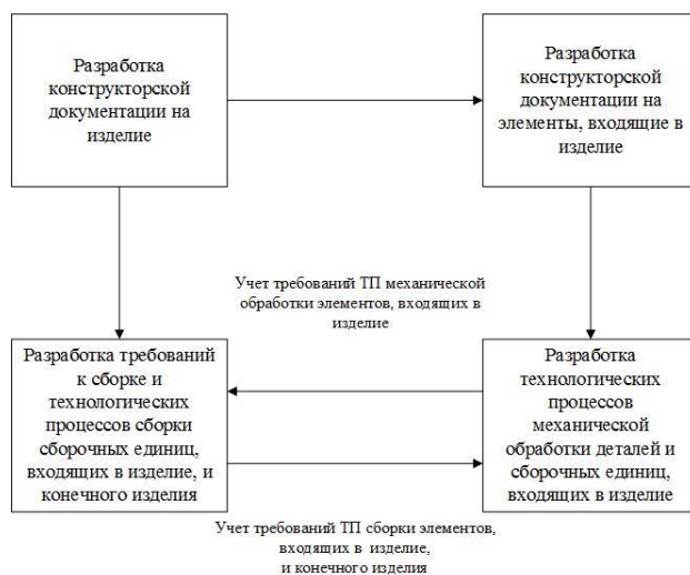
рис. 1. Связь между технологической подготовкой механообрабатывающего и сборочного производств
