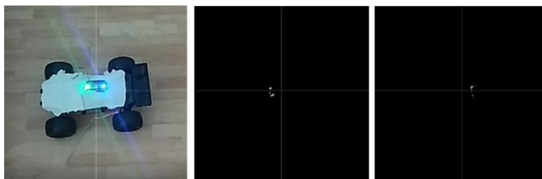
рис. 5 Поиск зелёной и синей метки на основе цветовой фильтрации изображения
