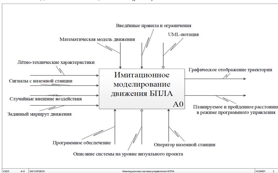
рис. 1. IDEF0-диаграмма имитационной модели системы управления БЛА
