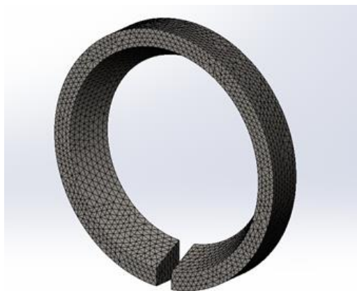
рис. 3 Конечно-элементная расчётная сетка
