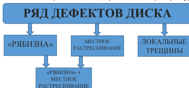
рис. 2 Основные дефекты диска авиационного двигателя
