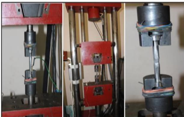
рис. 1. Испытания образцов из стали 12Х18Н10Т на разрушение на машине Р-10М-Авто
