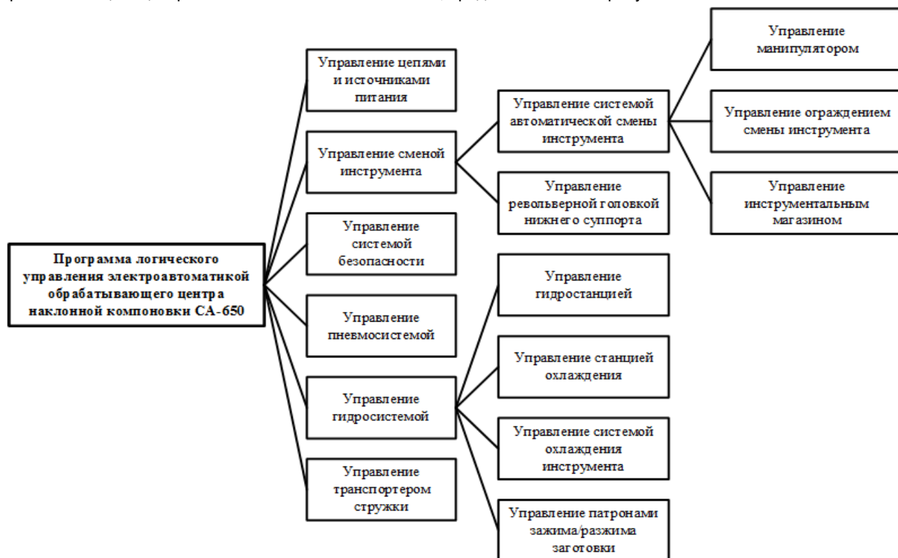
рис. 3. Декомпозиция задач логического управления обрабатывающего центра наклонной компоновки СА-650
