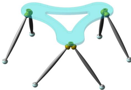
рис. 2 Пространственная кинематическая цепь параллельной структуры
