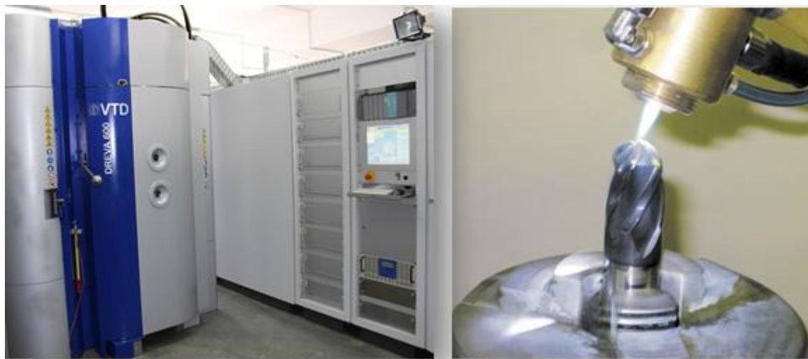
рис. 1 Установка для нанесения упрочняющих покрытий на инструмент с помощью ионноплазменной технологии
