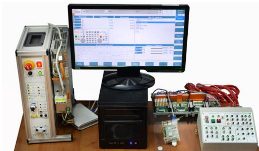
рис.4 Тестирование макетного образца разработанного решения с мониторингом данных по сети EtherCAT и SERCOS
