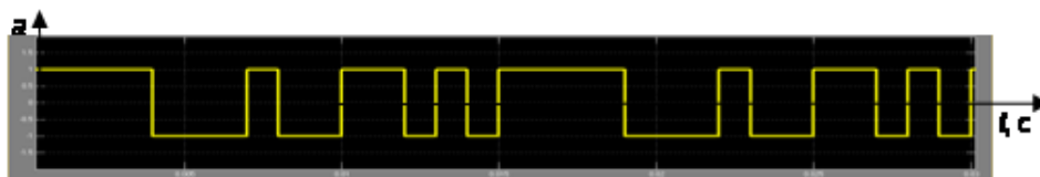
рис. 7 Временная диаграмма видеосигнала на основе кодов М-последовательности
