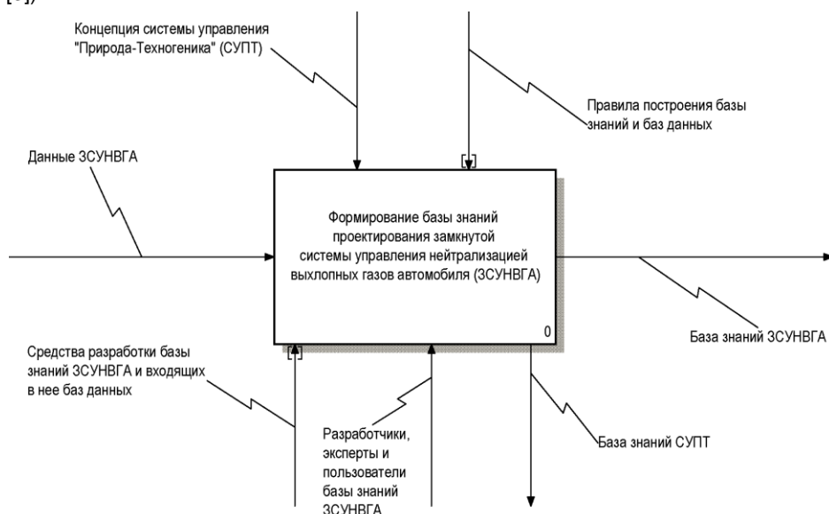
рис. 3. Диаграмма верхнего уровня процесса «Формирование базы знаний проектирования ЗСУНВГА» в нотации IDEF0
