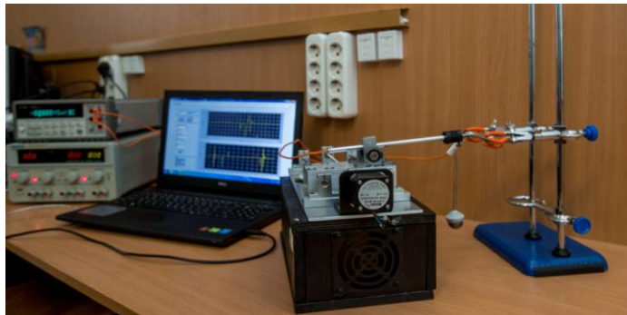
рис. 1 Прибор для спектрального анализа сигналов электрофизической диагностики Spectroelph-FRR и информационно-измерительная система функциональной электрофизической диагностики материалов и изделий
