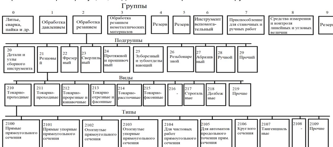
рис. 3 – Типовая классификация инструмента по виду обработки
