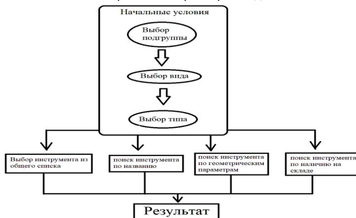
рис. 4 – Блок-схема поиска инструмента
