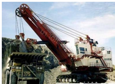
рис. 8. Пример совместной эксплуатации экскаватора и АТС при погрузке горной массы
