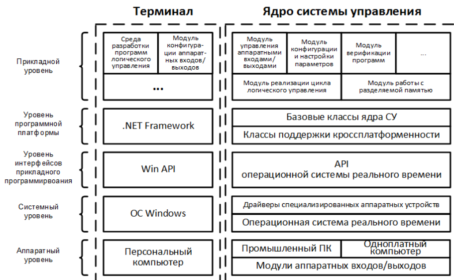
рис. 3 Модель систем логического управления по типу виртуальной машины
