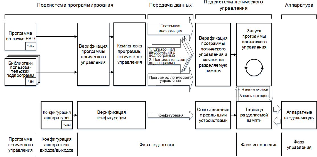
рис. 6 Модель поэтапного преобразования программы логического управления
